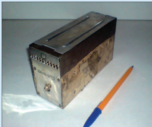
ША005-07 Кварцевый термостатированный генератор бортового радиокomплекса для КА «Марс», «Венера» Частота – 15 МГц. Год разработки – 1970
