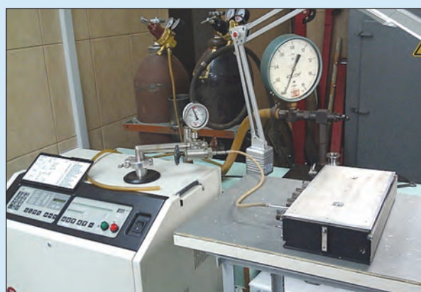
Гелиевый течеискатель с турбомолекулярной откачкой
