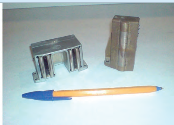
Магнитные головки запоминающих устройств ТМ-систем Разработаны в 1958–1960 гг.
