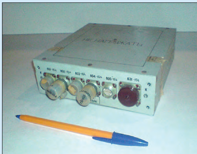
ТА735 Устройство согласования массивов ТМ-информации Предназначено для сопряжения бортовой вычислительной машины системы управления МКС с ТМ-системой БИТС2-12. Масса – 1,1 кг. Год разработки – 1981
