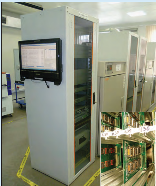
Система для проведения испытаний на безотказность и электротермотренировки
