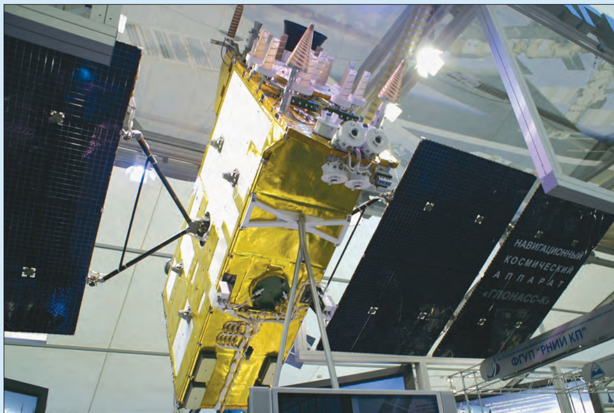
Космический аппарат «ГЛОНАСС-К» Третье поколение КА системы ГЛОНАСС. Срок активного существования – 10 лет. Запущен 26 февраля 2011 г.
