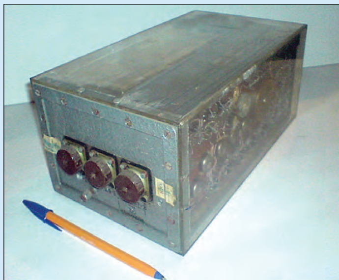
Э124 Старт-стопное ЗУ Применялось в ТМ системах навигационных и геодезических КА. Емкость памяти – 0,37 \cdot 10^6 дв. зн. Носитель информации – магнитная микропроволока. Масса – 4,8 кг. Год разработки – 1966
