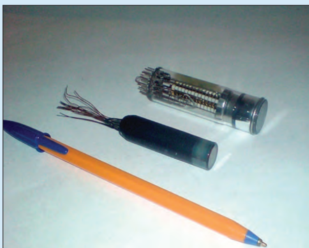
Фотоэлектронные умножители Разработаны в 1963 г. по ТЗ Института для космических телевизионных устройств
