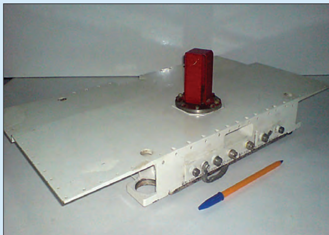
ША266 Усилитель мощности канала L1 Входит в состав аппаратуры БИНС КА «Глонасс». Выходная мощность – 17 Вт. Частота – 1,6 ГГц. Год разработки – 1980
