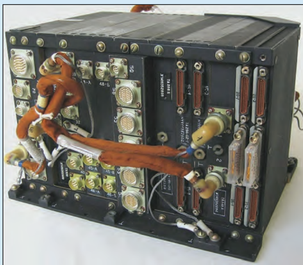
TA170 Моноблок системы сбора телеметрической информации (МССТИ) Входит в состав телекомандной системы (ТКС) КА «Канопус-В» и БКА. Год разработки – 2008
