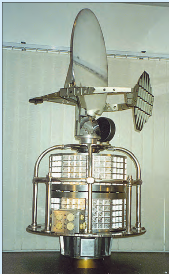
Микроволновый сканирующий радиометр температурного и влажностного зондирования атмосферы (МТВЗА)
