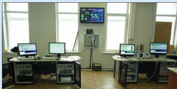
Аппаратный зал комплекса «Фобос». Слева — аппаратура автоматизированного управления КА. Справа — аппаратура обмена информацией с КА (2011 г.)
