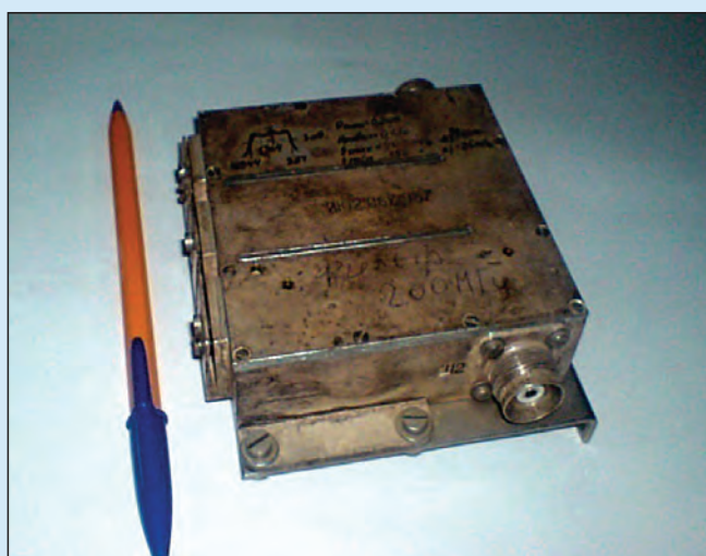
ДК-228 Высокочастотный полосовой фильтр Полоса пропускания по уровню 3 дБ – 40 МГц. Год изготовления – 1980
