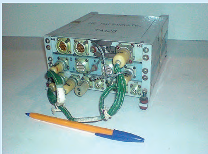
TA837B Вторичный источник питания Входит в состав ТМ-системы БИТС2-12 международной космической станции (МКС). Год разработки – 1998
