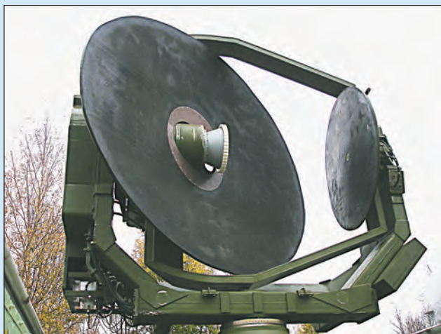
Антенно-фидерная система ВА 416 для мобильной КИС (2005 г.)
