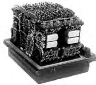
Усилитель-преобразователь сигналов слежения бортовых антенн
