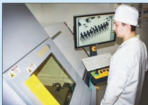
Установка рентген-контроля с функцией томографии
