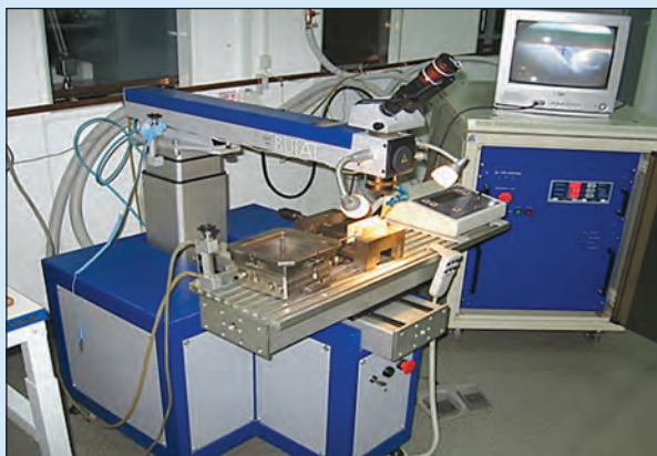
Установка для лазерной импульсной сварки
