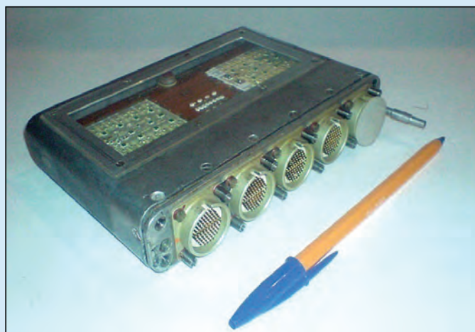
ТА229 Универсальный электронный коммутатор на бескорпусной элементной базе на 256 каналов Используется в бортовой аппаратуре ТМ-систем. Масса – 550 г. Год разработки – 1981. Год выпуска – 1985
