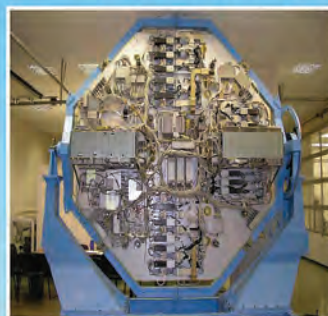
Бортовой ретранслятор для геостационарной орбиты
