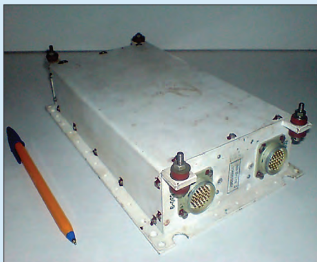
ША890-02 Источник вторичного питания усилителя мощности канала L2 (1,2 ГГц) для БИНС КА «Глонасс» Выходная мощность – 17 Вт. Год разработки – 2002
