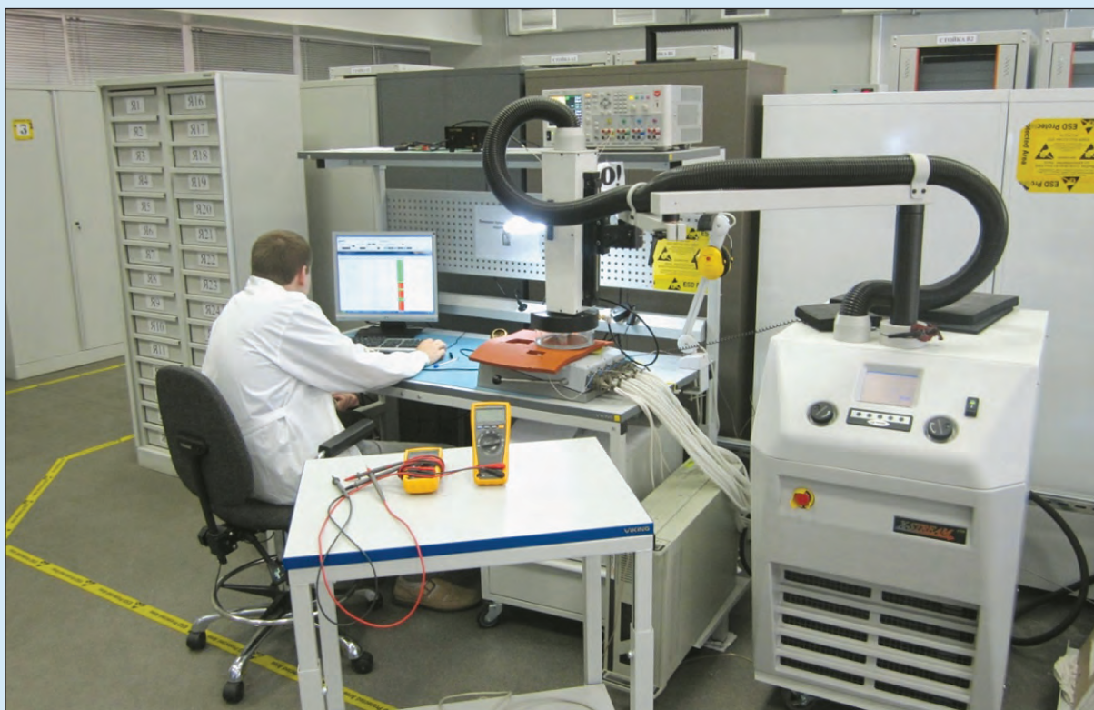
Рабочее место для проведения функционального и параметрического контроля ИС, испытаний на помехоустойчивость. В составе тестер СБИС «Формула-2К» (разработка Института)
