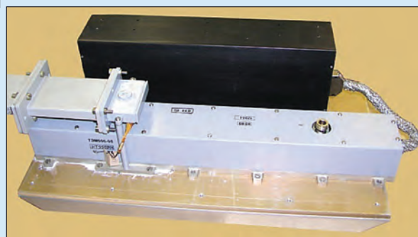
РА250 Приемный моноблок бортового ретранслятора «ПОТОК» космической системы связи ГОРИЗОНТ Использовался в системах фиксированной спутниковой связи и телевизионного вещания в диапазонах 4/6 ГГц и 11/14 ГГц, а также для подвижной спутниковой службы, в диапазоне 1,5/1,6 ГГц. Год разработки – 1977
