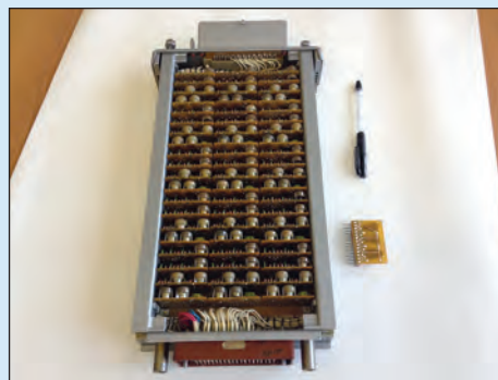
Унифицированный блок на модулях М3 аппаратуры СТИ-90М. 1970 г.
