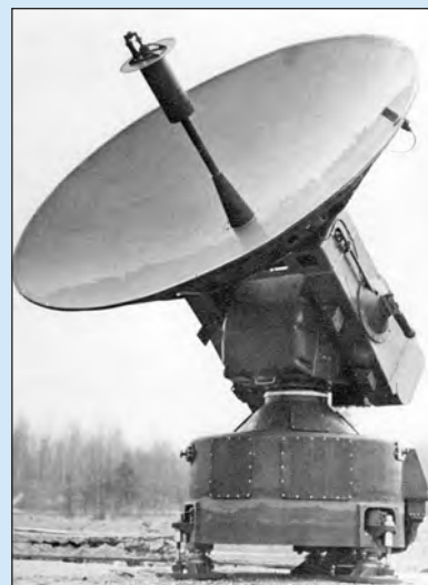
Антенна первой системы радиуправления межконтинентальной ракетой 8K71 (1960 г.)
