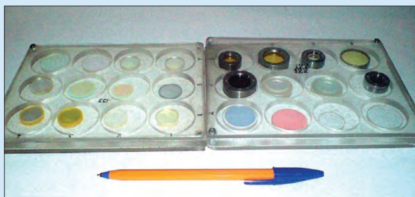
Набор интерференционных светофильтров Используются в оптических трактах аппаратуры ДЗЗ.
