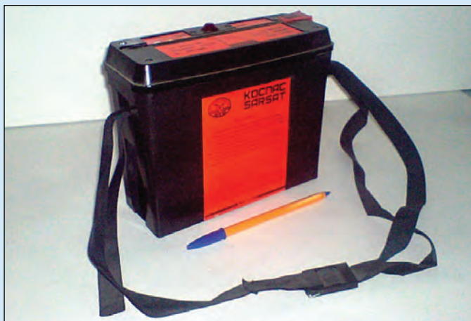
АРБ-ПК-10 Авиационный аварийный радиобуй с ручным включением Содержит передатчик спутникового канала, передатчик ближнего привода. Масса – 3 кг. Начало производства – 1990 г.
