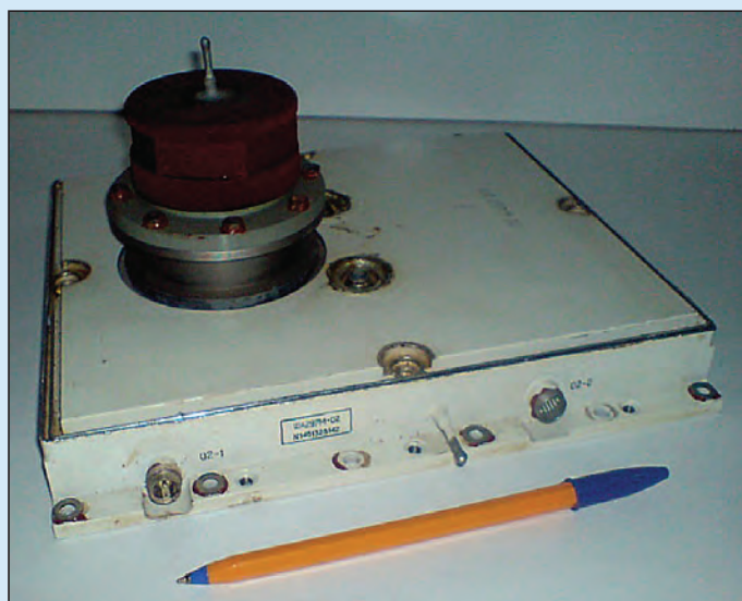
ША297М Усилитель мощности для БРТР Выходная мощность – 50 Вт. Рабочая частота – 485 МГц. Год разработки – 1980 Годы изготовления – 1982-1986
