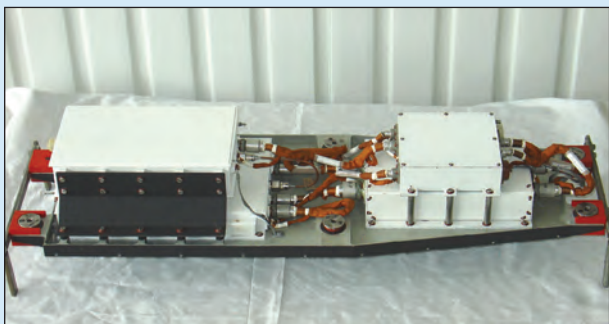
Передающее устройство L-диапазона системы БИС-С для КА «Сич-1М» (2006 г.)
