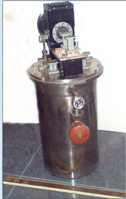
Малозумящий усилитель на НЕМТ транзисторах Ku-диапазон Применяется в наземной приемной аппаратуре КИС «Квант-Д». Коэффициент усиления K_y > 26 . Собственная температура шума K_{ш} > 500\text{K} . Охлаждение трехкаскадной термобатарей. Год разработки – 1985
