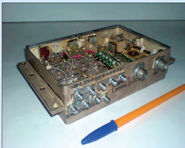
ША576-10 Модулятор бортового радиокомплекса КА «Ресурс» Пропускная способность – 128 Мбит/с. Частота – 8 ГГц. Модуляция четырехпозиционная ФМ. Год разработки – 1985
