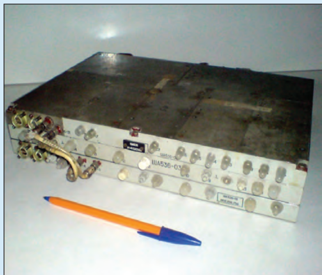
ША536 Синтезатор БРТР Опорная частота – 10 МГц. Диапазон выходных частот – 8-100 МГц. Год разработки – 1985
