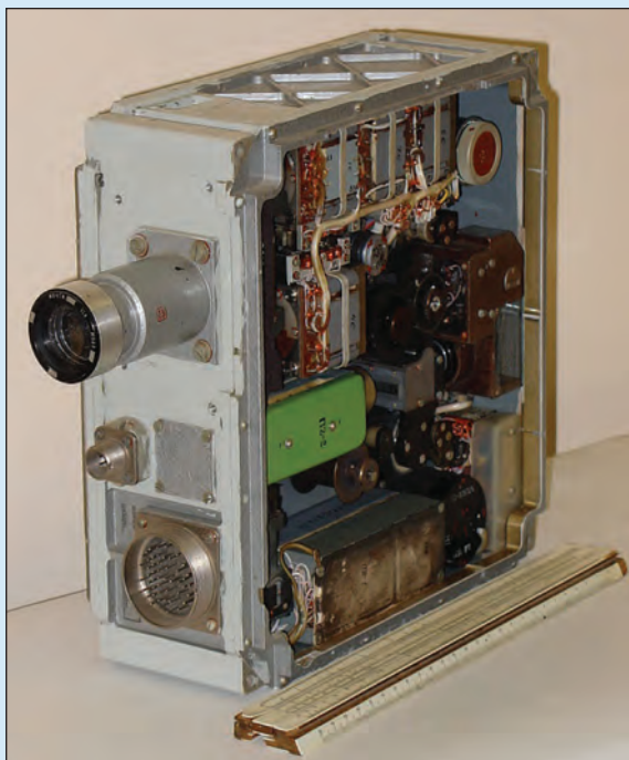
ФТУ 15П52 Фототелевизионное устройство Предназначено для съемки обратной стороны Луны. Обеспечивает работу в условиях невесомости и химическую защиту пленки от радиации. Масса – 6 кг. Год разработки – 1965
