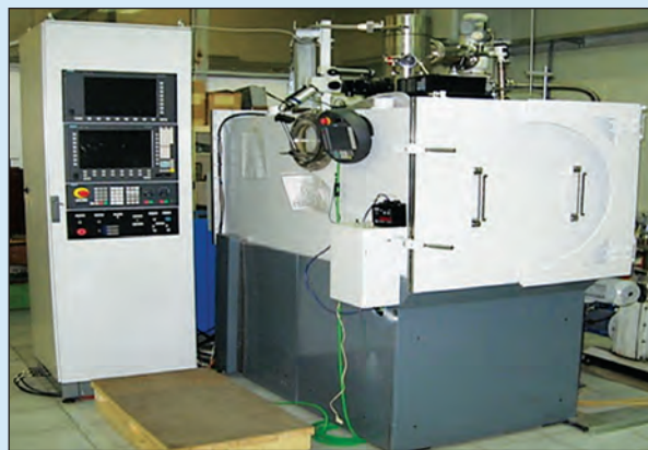
Установка для электронно-лучевой сварки в вакууме ЭЛУ-08КП
