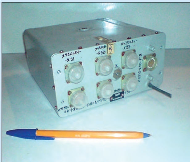
TA251 Локальный коммутатор температурный (ЛКТ) Предназначен для сбора информации от ТМ-датчиков станции МКС и транспортных кораблей «Союз». Масса – 1,8 кг. Год разработки – 1997
