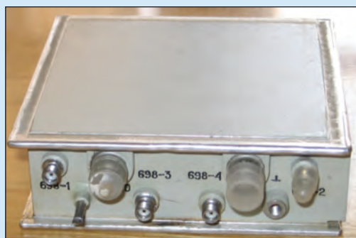
Герметизация электронно-лучевой сваркой в вакууме
