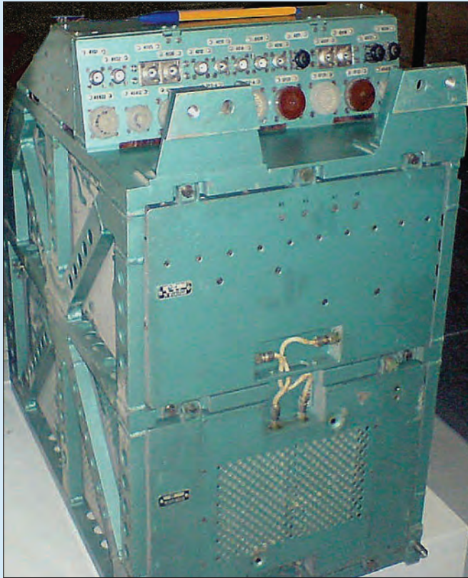
ЦА907Б БА КИС для КА «Экспресс», «Sesat» С-диапазон Масса – 57 кг. Год разработки – 1991
