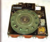
Э103 малогабаритное ЗУ на магнитной ленте 8,25мм. Конструкция кассеты над кассетой. Объем памяти 16Мбит Масса 2,1кг
