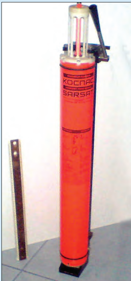
АРБ-МК Морской аварийный радиобуй с ручным отделением Содержит передатчик спутникового канала, передатчик ближнего привода, световой маяк. Масса – 5 кг. Начало производства – 1984 г.
