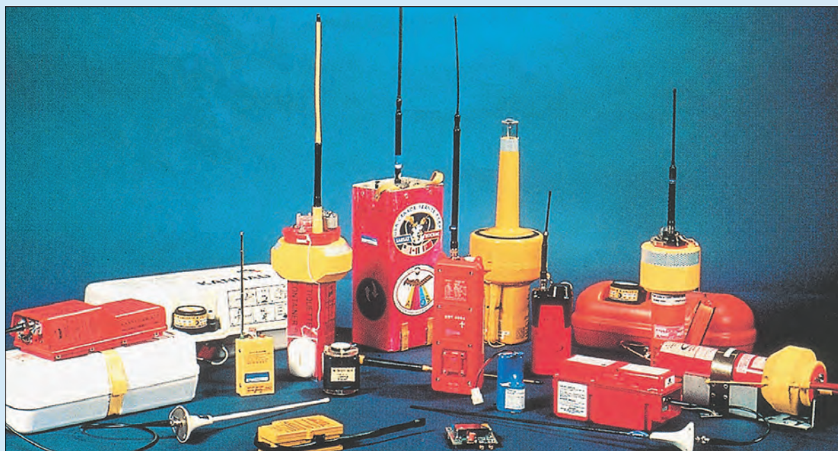
Различные типы аварийных радиобуев (АРБ) системы КОСПАС-САРСАТ
