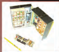
Старт-стопное ЗУ на магнитной проволоке ЗА080. Объем памяти 5Мбит Диаметр проволоки 25мк Масса ЗУ 2,4кг Масса ПГМ 280г
