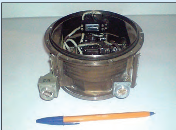
Спектроразделительный блок с приемниками ПЗС многозонального сканирующего устройства МСУ-Э (ЭА098) Служит для разделения светового потока на три спектральных диапазона. Год разработки – 1977
