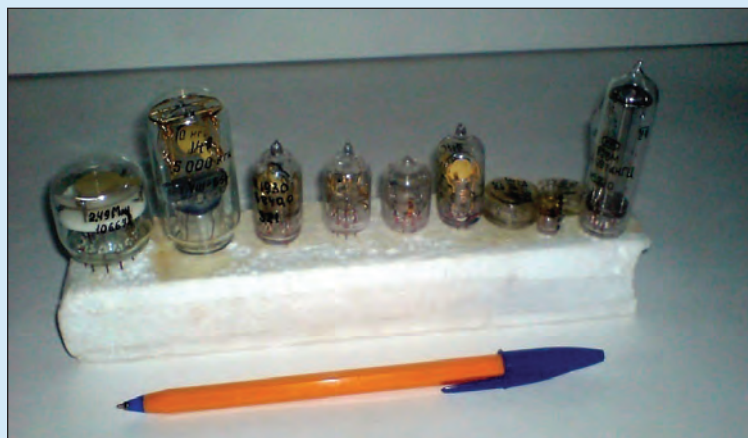
Кварцевые резонаторы изгибных колебаний Высокодобротные резонаторы. Обладают большой долговременной стабильностью частоты. Применяются в бортовых приборах – кварцевых задающих генераторах и синтезаторах частоты. Годы изготовления 1970-1990
