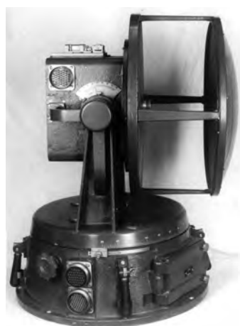
Пеленгационная антенна системы локационного наведения наземных антенн
