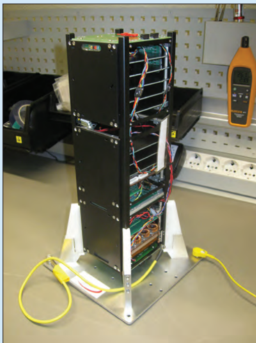
Экспериментальный космический аппарат нанокласса (ЭН КА) с приемником АИС 2011 г.
